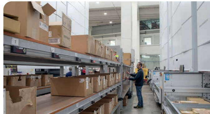
Put-to-Light-system som ansluts till WMS
